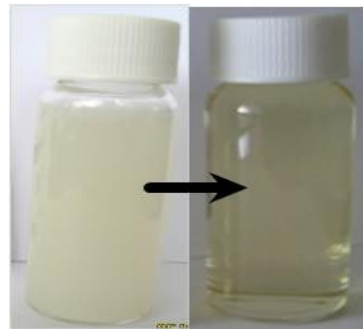
شکل ۲. نانوامولسیون سنتز شده حاوی ۵٪ اسانس زیره قبل (چپ) و بعد (راست) از فرآیند سونیکاسیون.
