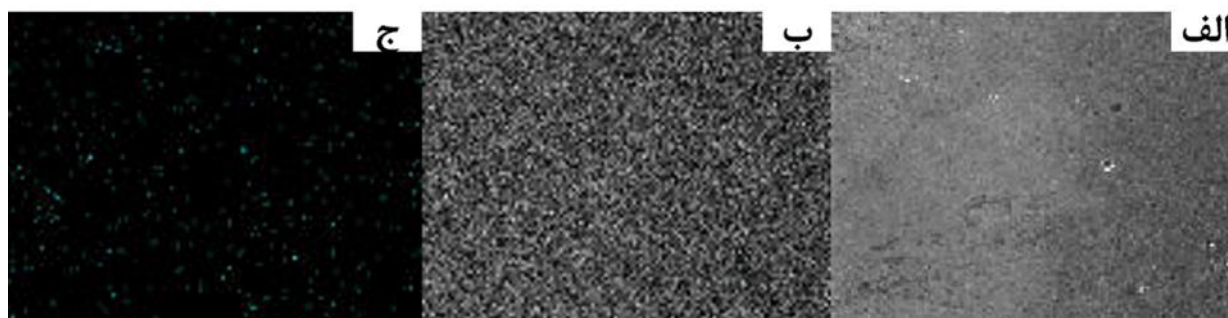
شکل ۳. الف) تصویر میکروسکوپ الکترونی رویشی از آلیاژ مس-قلع با درصد وزنی ۰٫۵٪ با سرعت و دمای ریخته‌گری به ترتیب پنج متر بر دقیقه و ۱۱۸۰ درجه سلسیوس، ب) آنالیز عنصری توزیع مس در آلیاژ و ج) آنالیز عنصری توزیع قلع در آلیاژ.
