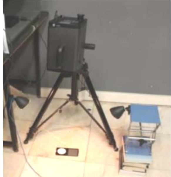
شکل ۳. نحوه قرارگیری منبع نور، نمونه و دوربین.
