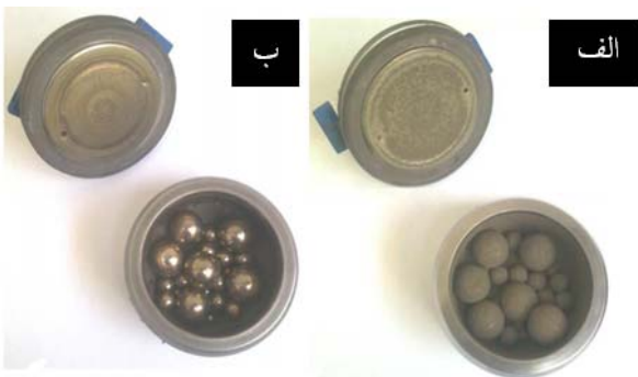
شکل ۴. تاثیر PCA بر فرآیند آلیاژسازی پودر CuZnAl (نمونه ۵۶ ساعت تحت حفاظت گاز آرگون)؛ (الف) استفاده از متانول به عنوان PCA، (ب) استفاده از اسید استتاریک به عنوان PCA.
