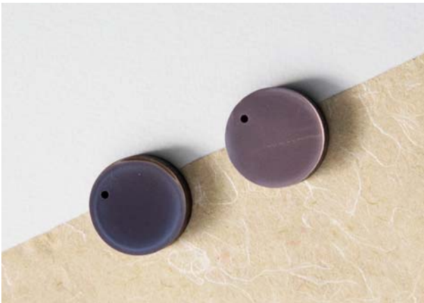
شکل ۲. رنگ ظاهری پوشش با ۱۰ و ۴۲ درصد اتمی آلومینیوم به ترتیب از راست به چپ.
