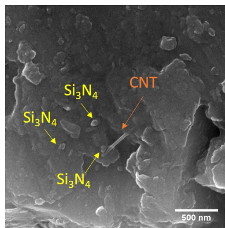
شکل ۱۲. توزیع مناسب فاز ثانویه در زمینه آلومینیوم نمونه حاوی ۱۵ درصد وزنی نیتريد سيليسيم حاوی پنج درصد وزنی نانولوله کربنی سیتر شده به روش پلاسمای جرقه‌ای.
