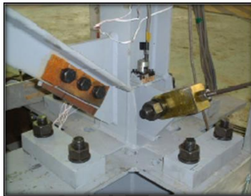
شکل (۱) مدل فیزیکی کف ستون تسلیم شونده
