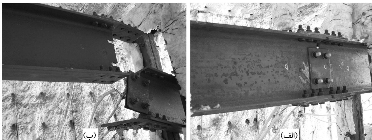
شکل ۸: اتصال S-1: الف) قبل از آزمایش، ب) مود خرابی پس از آزمایش
