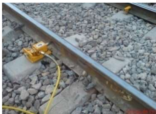
شکل ۱: آزمایش تراورس منفرد (STPT)[۲].
