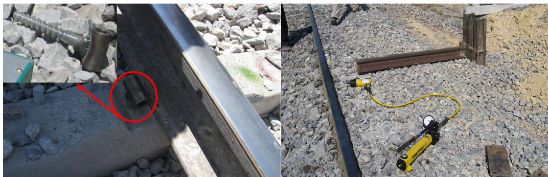
شکل ۴: ساخت تکیه‌گاه برای اعمال بار (سمت راست) و قطعه واسطه ساخته شده و نصب آن (سمت چپ).
