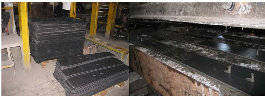
شکل ۲: اتصال پدها در زمان بتن ریزی به سطح پایینی تراورس‌ها در کارخانه تولیدی-شکل کلی پدها.
