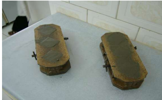
شکل ۳: قالب مکعبی 5*5*5 پر شده با ملات.
