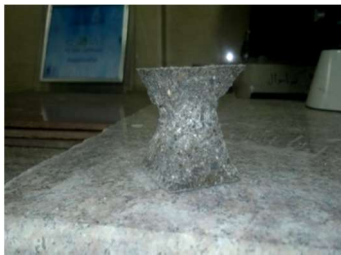
شکل ۵: نحوه شکست نمونه.
