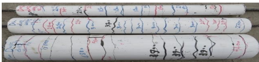
شکل ۵الف: مقایسه ترک‌های موجود در نمونه‌ها با میلگرد قطر ۱۲ از نوع AII (نیروها برحسب کیلوگرم).
