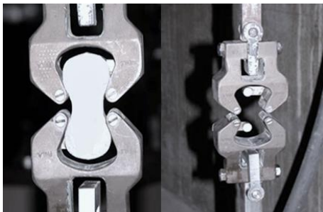
شکل ۲: نمونه و دستگاه آزمون کشش نمونه هشتی شکل
