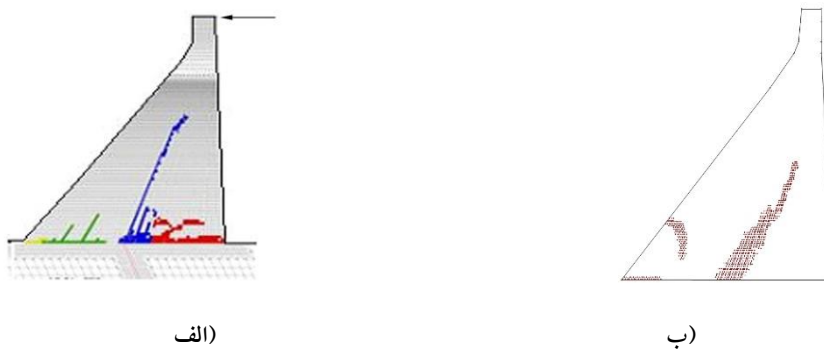
شکل ۷: پروفیل ترک خوردگی سد در اثر حرکت نرمال گسل در میانه سد و تحت زاویه تقریبی ۶۰ درجه به ازای تغییر مکان ۱۰ میلی متر در حالت مخزن پر، (الف) تحقیق حاضر، (ب) مرجع [۲۱].
