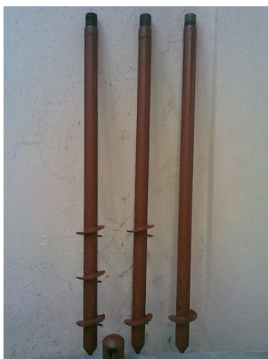
شکل ۳: شمع های استفاده شده در دستگاه FCV.
