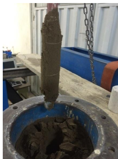
شکل ۲: انجام آزمایش بارگذاری شمع پیچی سه پره.
