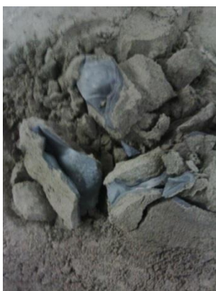
شکل ۵: تزریق سیمان در خاک اطراف شمع پیچی در دستگاه FCV.
