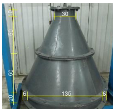
شکل ۱: نمای اصلی به همراه ابعاد دستگاه FCV.
