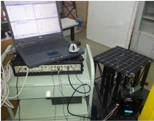
شکل ۱: مدل اسکله مورد مطالعه به همراه چیدمان تجهیزات جهت آنالیز مودال تجربی.
