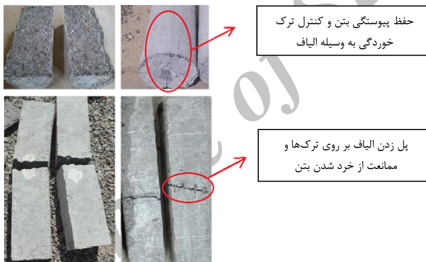
شکل ۸: مقایسه بتن بازیافتی الیافی (سمت راست) و بدون الیاف (سمت چپ) از لحاظ ترک خوردگی و شکست.
