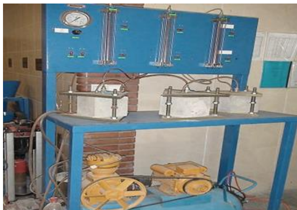
شکل ۲. ب: دستگاه اندازه‌گیری عمق نفوذ آب.
