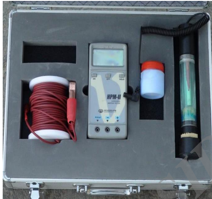
شکل ۳: نیم پیل مورد برای اندازه‌گیری پتانسیل خوردگی.
