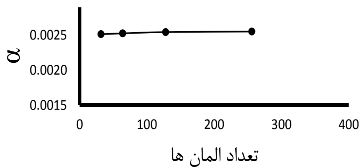
شکل ۲۲: تغییرات ضریب α در کنج باز شو ۱۱ درصد صفحه SSSS تقویت شده تحت اثر بار گسترده در تمام صفحه - روش اجزاء محدود
