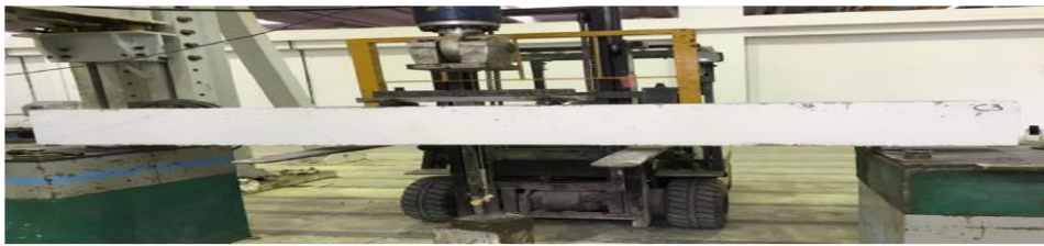
شکل ۳: نحوه‌ی بارگذاری خمشی چهار نقطه‌ای تیرهای تهیه شده توسط شاترات و همکارانش [۹]
