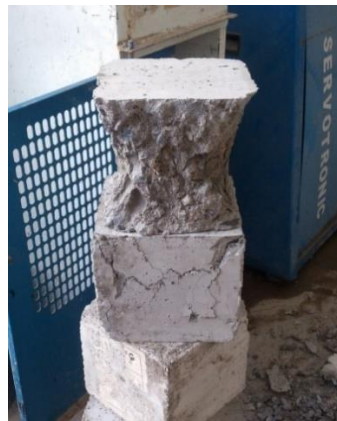
شکل ۲: حالت رضایت بخش گسیختگی نمونه های مورد آزمایش
