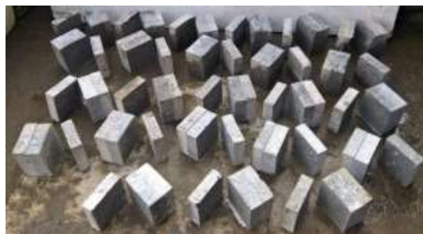
شکل ۳: نحوه گسیختگی نمونه ها در روش پوش اوت
