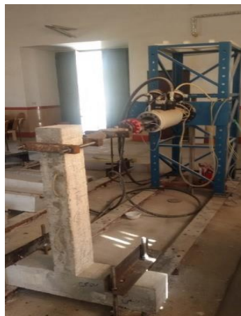
شکل ۳: اتصال نمونه به دستگاه و کف صلب
