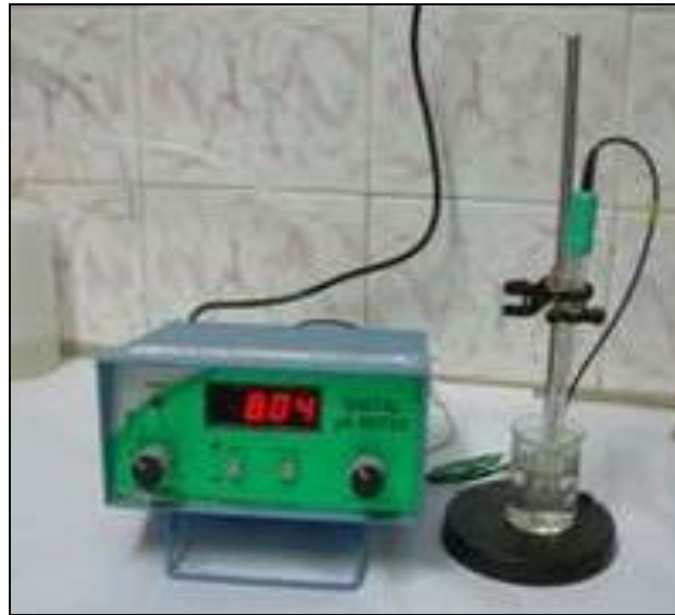
شکل ۴: دستگاه تعیین مقدار اسیدیته گروت (pH meter)
