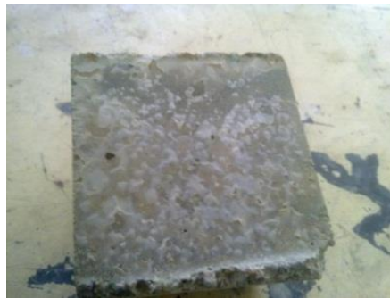
شکل ۱۱: لایه نانورس تشکیل شده بر وجه نمونه مکعبی پس از ۱۸۰ روز عمل‌آوری در نمونه حاوی ۱٪/۵ نانورس
