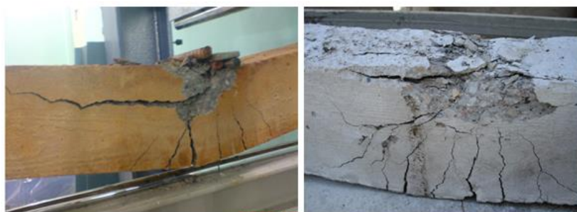
شکل ۸: ترک‌های ایجاد شده در تیرها پس از آزمایش خمشی (الف) تیر در سن ۲۸ روز (ب) تیر پس از ۶ ماه قرارگیری در محیط خورنده
