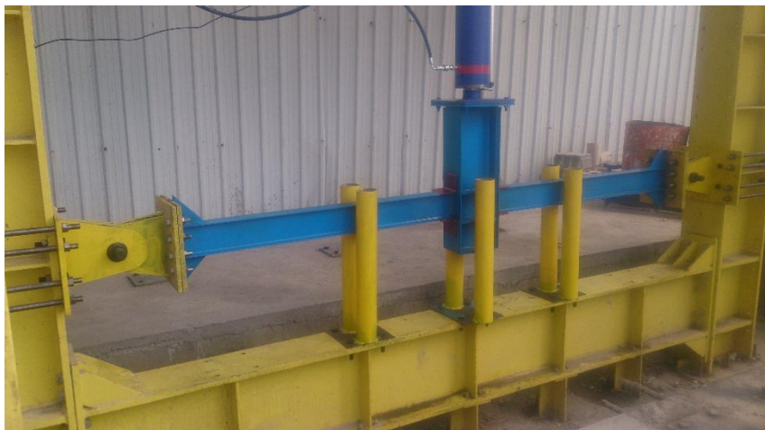
شکل ۶: نمای کلی از نمونه اتصال جوشی آزمایش شده در دانشگاه صنعتی شیراز
