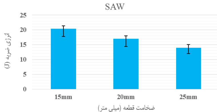
شکل ۱۴: میانگین نتایج تست ضربه الکترو زبرپودری SAW
