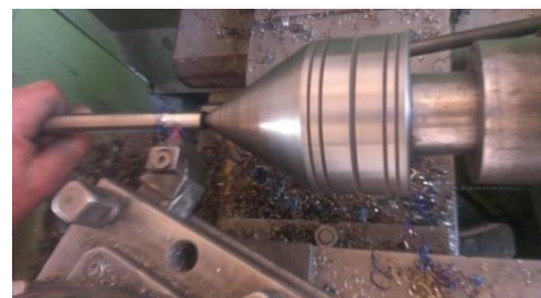
شکل ۷: تراشکاری جهت رزوه نمودن SMA
