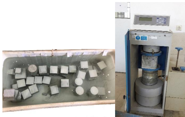
شکل ۳: عمل‌آوری نمونه‌ها و آزمایش مقاومت فشاری
