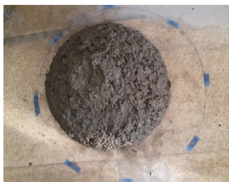
شکل ۱۱: بتن با ویسکوزیته بالا حاوی ۰/۲۴ درصد وزن آب VMA
