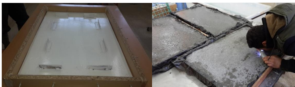
شکل ۵: قالب دال و چگونگی اندازه‌گیری عرض ترک
