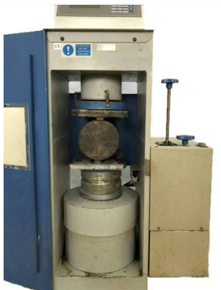
شکل ۴: آزمایش مقاومت کششی
