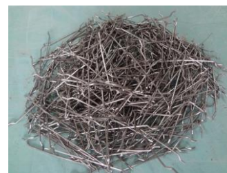
شکل ۱: الیاف فولادی و پلاستیکی مورد استفاده
