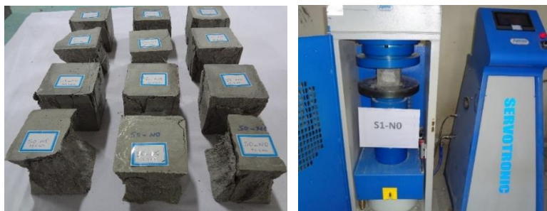
شکل ۱۲: انجام آزمایش مقاومت فشاری
