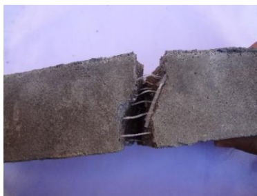
شکل ۱۶: انجام آزمایش خمشی سه نقطه ای تیرها
