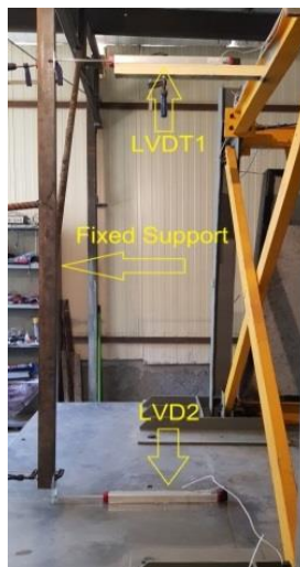
شکل ۸: نصب جابه‌جایی سنجه‌ها روی مدل آزمایشگاهی.
