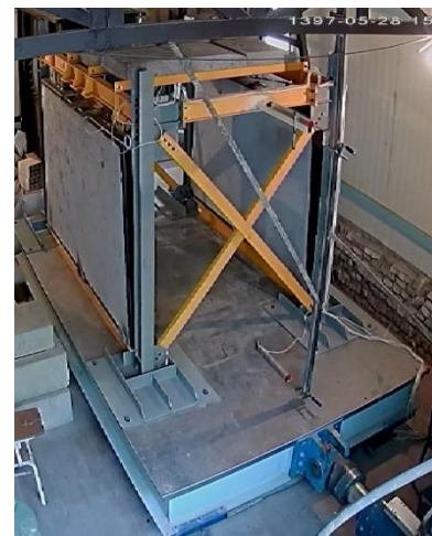
شکل ۱۵: نصب مدل آزمایشگاهی روی میز لرزه
