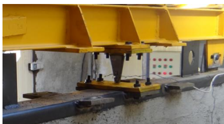
شکل ۱۶: حذف ۲ اتصال قاب به دیوار و ایجاد سازه MFI.
