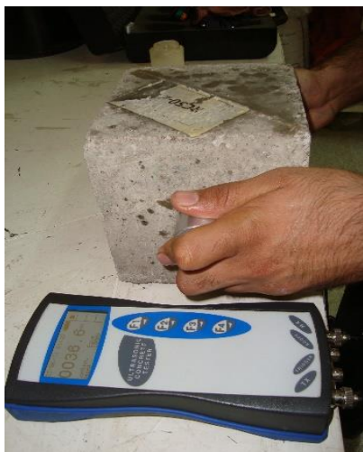
د: آزمایش تعیین سرعت انتشار امواج فراصوت در سن ۲۸ روزه
