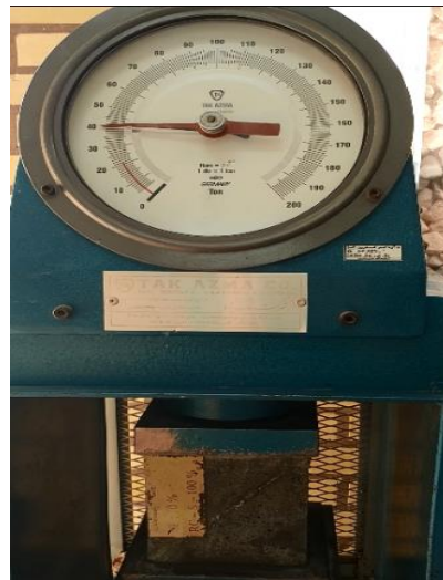
الف: آزمایش تعیین مقاومت فشاری در سنین مختلف
