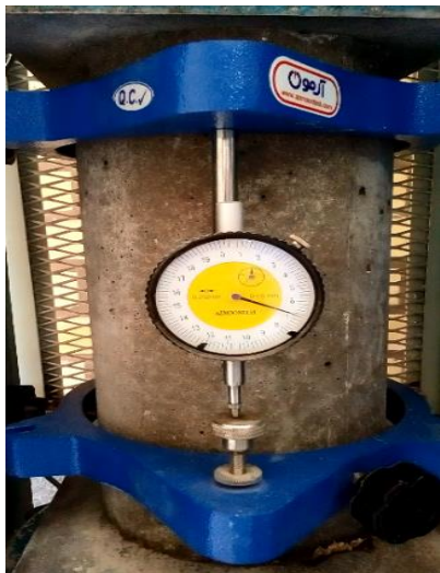
ب: آزمایش تعیین ضریب ارتجاعی استاتیکی در سن ۲۸ روزه
