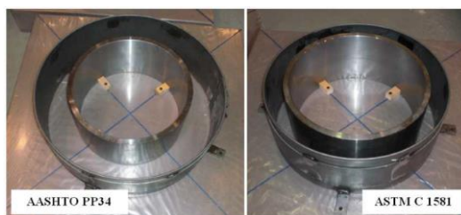
شکل ۱۰ - حلقه‌های استاندارد مطابق با استانداردهای آمریکا (تصویر سمت راست) و آشتو (تصویر سمت چپ) جهت آزمون حلقه [۶۲]
