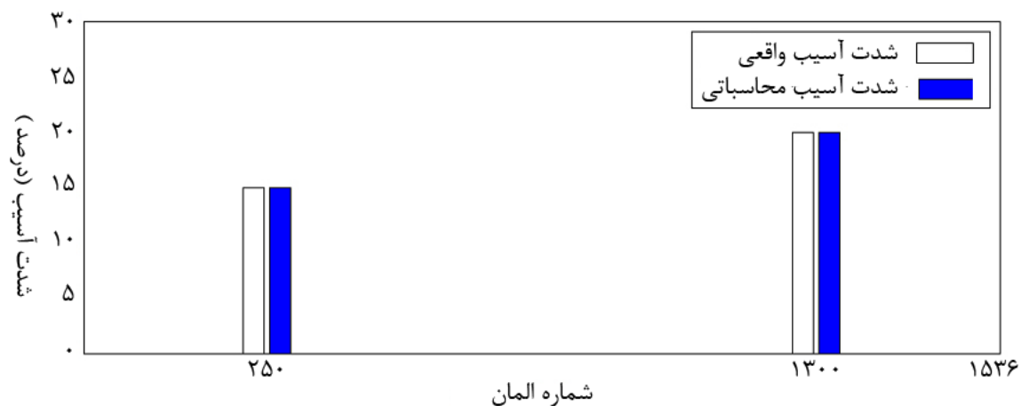
شکل ۹: شدت آسیب به دست آمده از روش بهینه یابی سیستم ذرات باردار برای سناریوی آسیب شماره ۲
