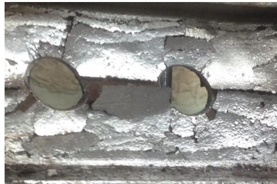
شکل ۱۰: شروع تغییر شکل در جان عضو زانویی و در نزدیکی تکیه‌گاه‌ها در هر دو نمونه
