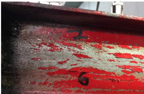
شکل ۱۰: شروع تغییر شکل در جان عضو زانویی و در نزدیکی تکیه‌گاه‌ها در هر دو نمونه
