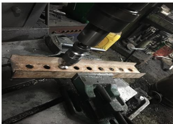
شکل ۶: پخ زدن لبه سوراخ‌ها به منظور جلوگیری از تمرکز تنش در لبه‌های سوراخ‌ها
