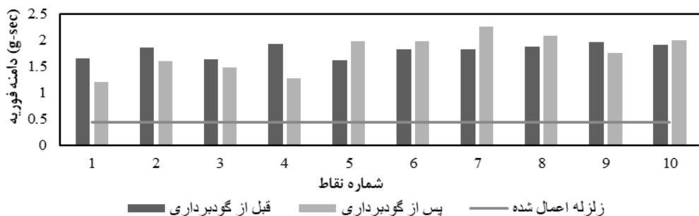
شکل ۲۷: بیشینه دامنه فوریه نقاط واقع در ناحیه روانگرا شده و زلزله اعمالی (مدل چهارم).
