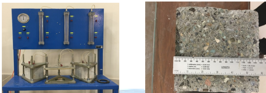
شکل ۱۲: نحوه انجام آزمایش عمق نفوذ بر اساس استاندارد DIN 1048
