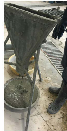
شکل ۶-الف: نحوه انجام آزمایش قیف V شکل ۶-ب: نتایج آزمایش قیف V برای انواع طرح اختلاط های مورد استفاده شکل ۶: بررسی آزمایش قیف V برای انواع طرح اختلاط های مورد استفاده
