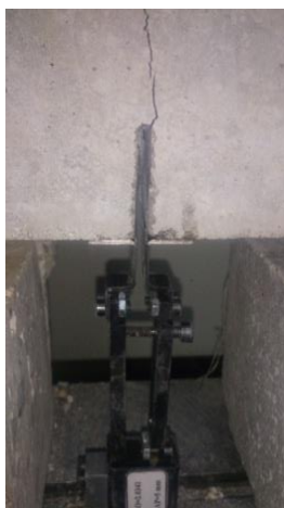
ب- نحوه قرارگیری سنسور اندازه گیری بازشدگی دهانه ترک
