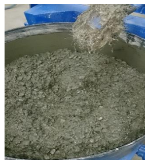
الف- ساخت نمونه‌های بتنی
