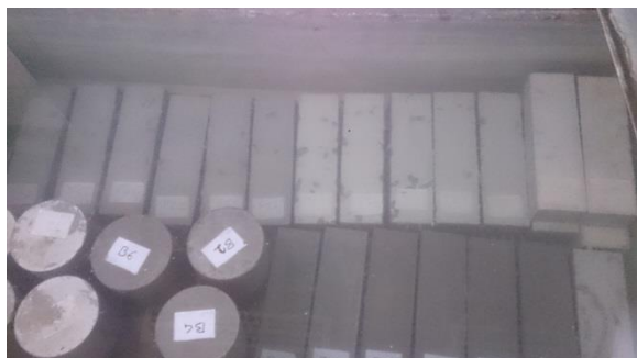
ب- عمل‌آوری نمونه بتن الیافی
