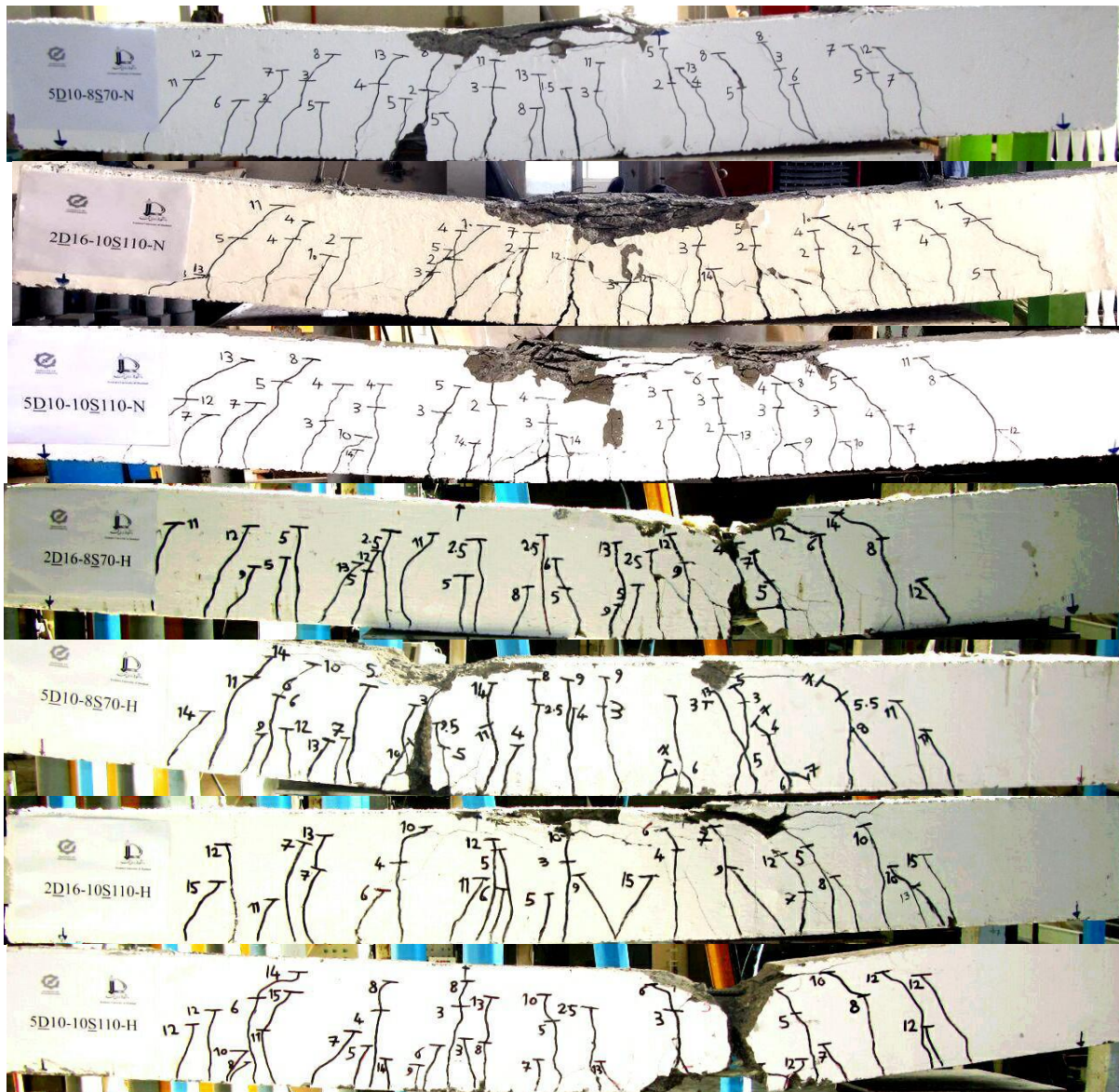
شکل ۹: چگونگی ترک خوردگی و شکست نمونه‌های آزمایشگاهی با نسبت آرمانتور کم.
