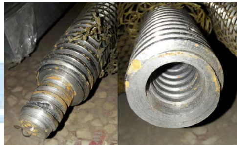
شکل ۵: نحوه اتصال دو بال اسکرو با پیچ به نحوی که شیارهای حرکت ساچمه در امتداد هم باشند.
