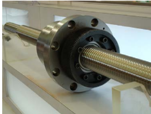
شکل ۳: مهره بال اسکرو از نوع گردان و حلقه انتهایی.
