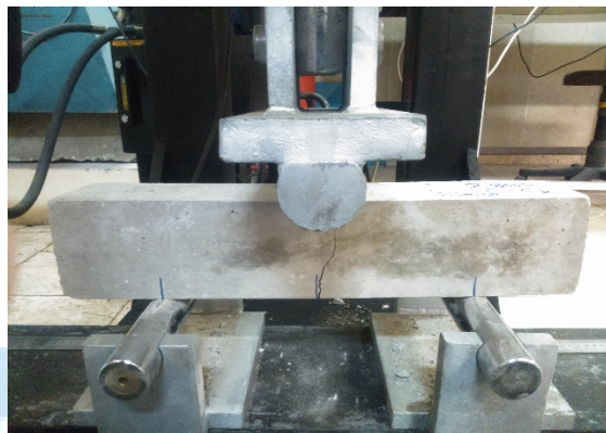
شکل (۳) شکستن تیر توسط دستگاه خمش
