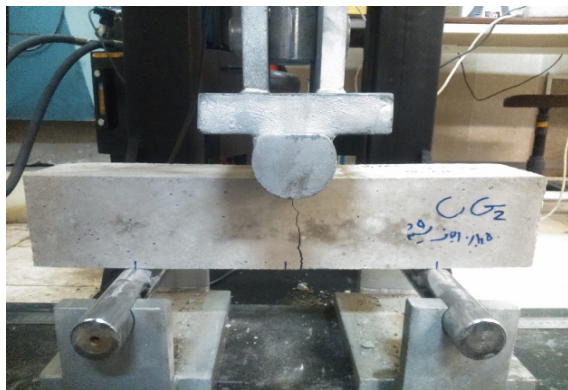
شکل (۳) شکستن تیر توسط دستگاه خمش
