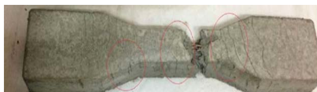
شکل ۳: نمونه ای از الگوی ترک خوردگی در نمونه HPCRCC.
