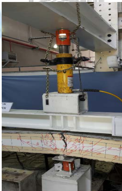
شکل ۶: طریقه اعمال نیرو توسط جک هیدرولیکی به تیرهای سراسری.
