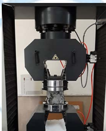
شکل ۱: تجهیزات آزمایش تعیین مقاومت فشاری بتن.
