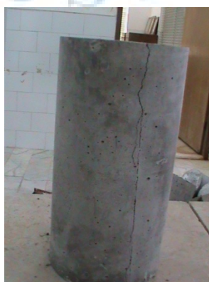
شکل ۹: شکست نمونه‌ها در آزمایش شکافت.
