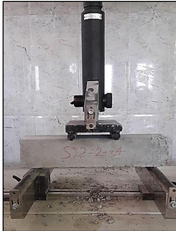
(ب) نمای کلی تیر بتنی در زیر جک بارگذاری
