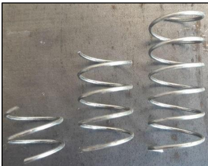
پ- فنر با قطر ۱۶ میلی متر
