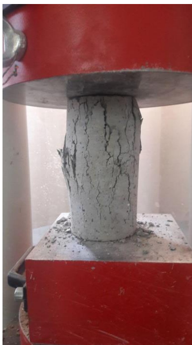
شکل ۵: آزمایش مقاومت فشاری نمونه ها
