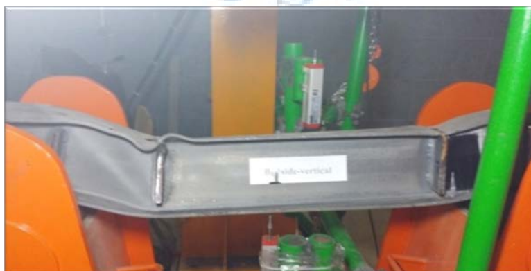
شکل ۹: ایجاد کمانش قطری در ناحیه برشی پس از جدا شدن نوارهای CFRP در تیر B2
