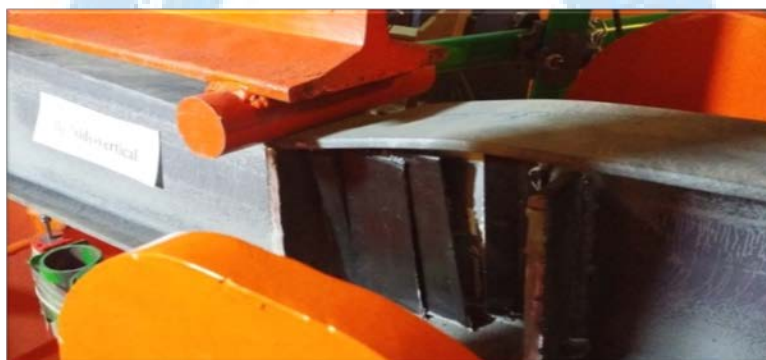
شکل ۸: جداشدگی (Debonding) و شکاف خوردن (Splitting) در تیر B2
