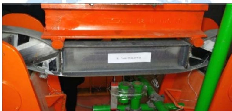
شکل ۱۳: جدا شدگی (Debonding) و شکاف خوردن (Splitting) در CFRP در نمونه تیر B5
