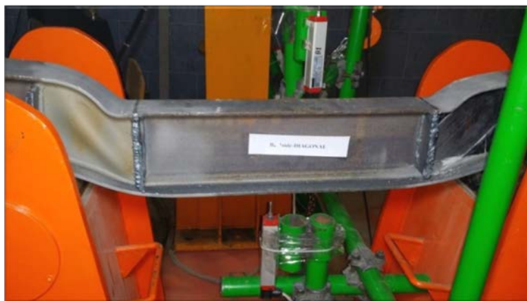
شکل ۱۲: وقوع پدیده جدا شدگی ورق CFRP در نمونه تیر B4
