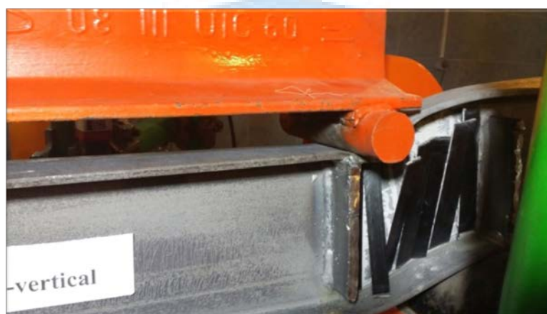
شکل ۱۱: جداشدگی (Debonding) و شکاف خوردن (Splitting) در نمونه تیر B3
