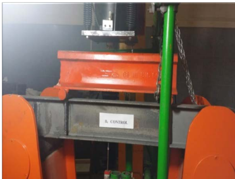
شکل ۴: آماده سازی انجام آزمایش شامل جک هیدرولیکی، تیر بارگذاری، نمونه تیر آزمایشگاهی و تکیه گاههای غلطکی
