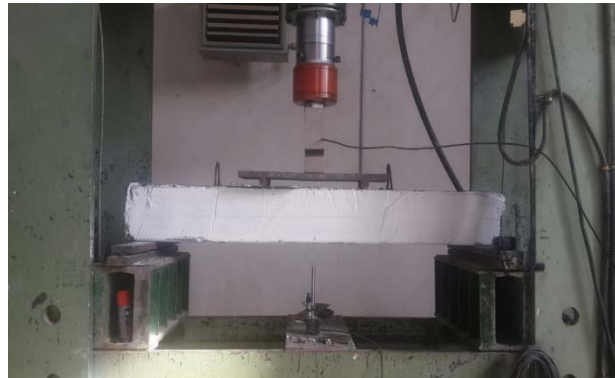
شکل ۹: دستگاه بارگذاری و نحوه ی بارگذاری نمونه ها
