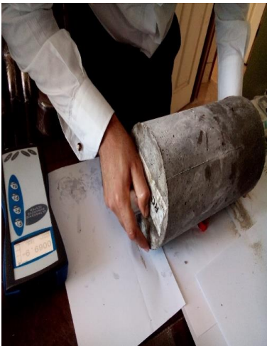
تصویر ۳: نمایی از انجام آزمایش‌های مقاومت فشاری، مقاومت کششی دونیم‌شدن و تعیین سرعت انتشار امواج فراصوت
