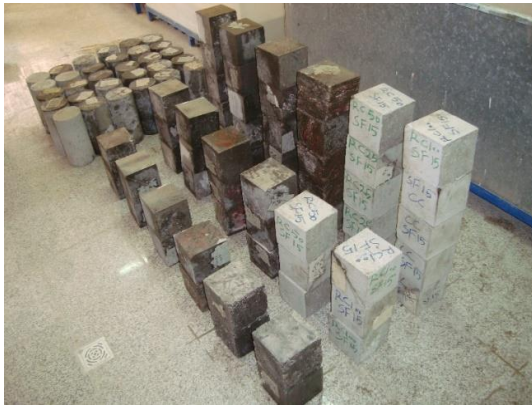
تصویر ۲: برخی از نمونه‌های ساخته شده و شرایط عمل‌آوری و نگهداری آن‌ها
