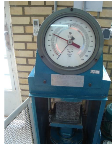
تصویر ۳: نمایی از انجام آزمایش‌های مقاومت فشاری، مقاومت کششی دونیم‌شدن و تعیین سرعت انتشار امواج فراصوت
