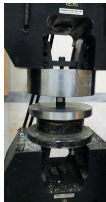
شکل ۲: نمونه‌های تست تعیین مقاومت فشاری
