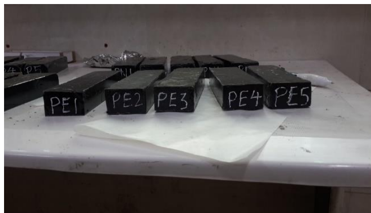
شکل ۴: نمونه های تست تعیین مقاومت خمشی
