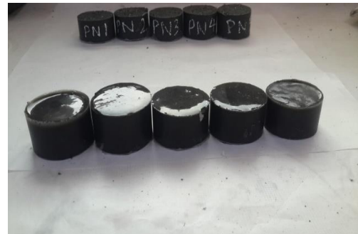
شکل ۵: نمونه‌های تست تعیین مقاومت کششی
