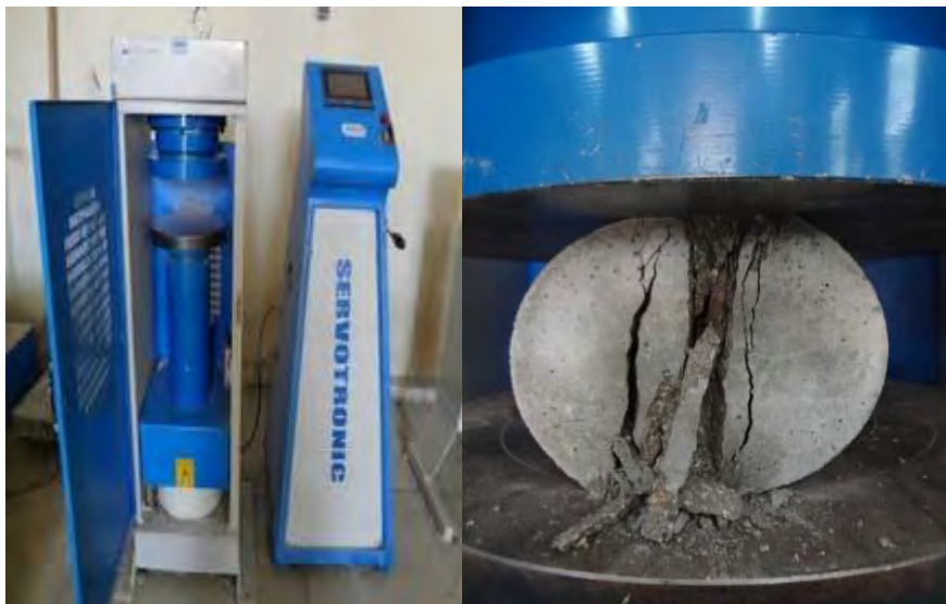
شکل ۵. نحوه انجام آزمایش تست کششی
