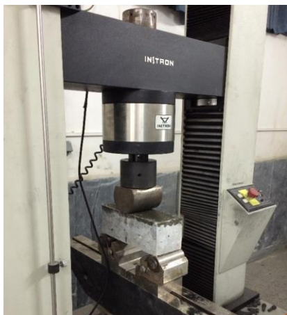
شکل ۱: مجموعه دستگاه برای آزمایش نمونه ها، نمونه با ارتفاع ۱۰ سانتی متر (چپ)، ارتفاع ۲۰ سانتی متر (راست)
