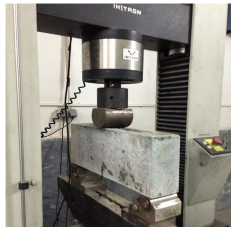
شکل ۱: مجموعه دستگاه برای آزمایش نمونه ها، نمونه با ارتفاع ۱۰ سانتی متر (چپ)، ارتفاع ۲۰ سانتی متر (راست)
