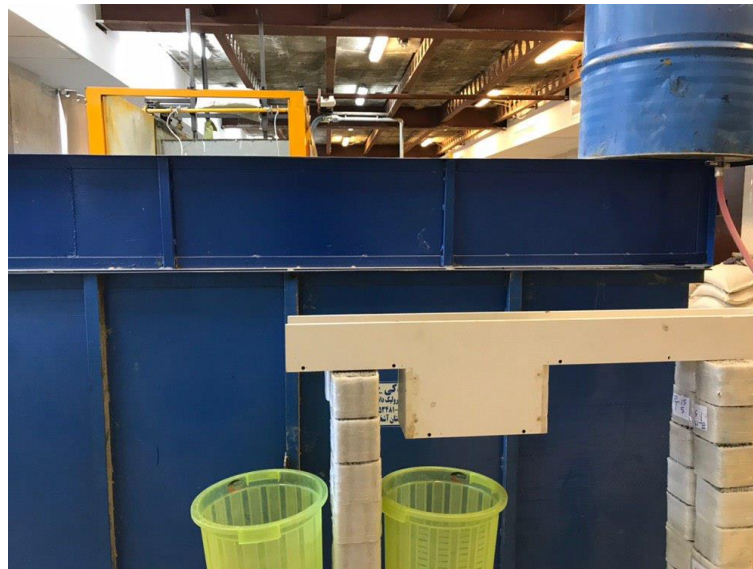
شکل ۳: سیستم اندازه گیری نفوذپذیری نمونه های بتن متخلخل
